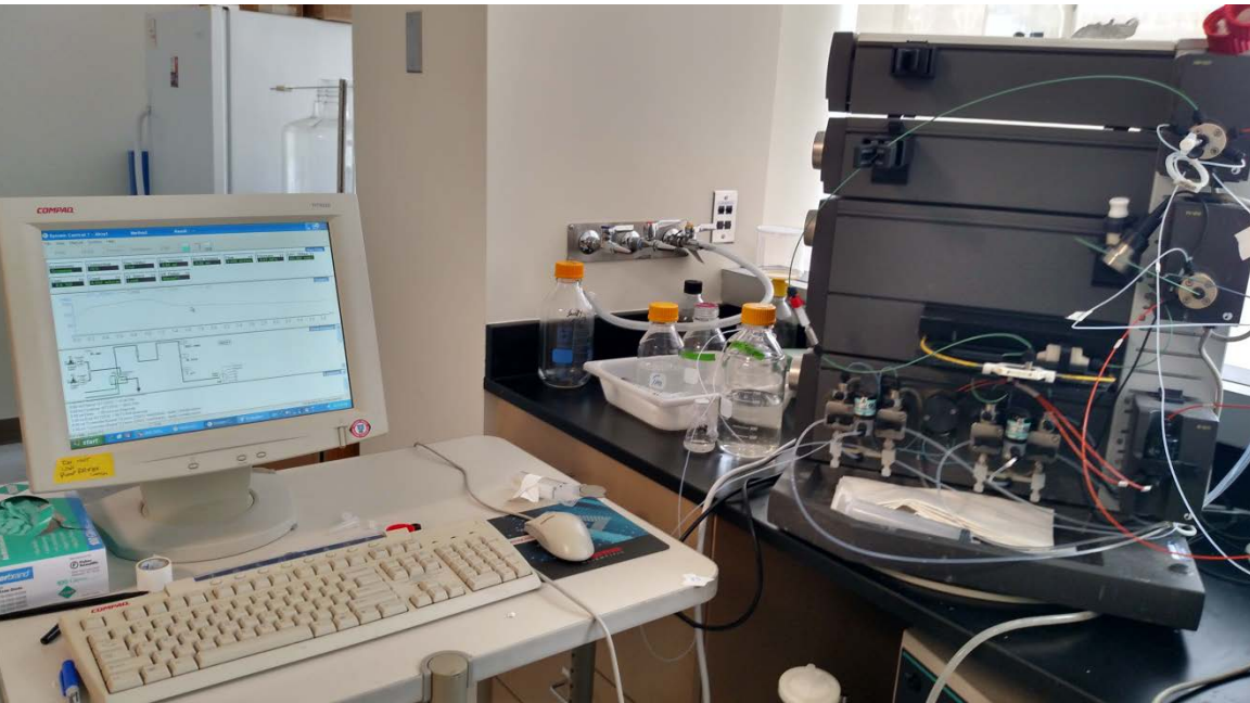
Äkta Purifier FPLC (Chromatography)
